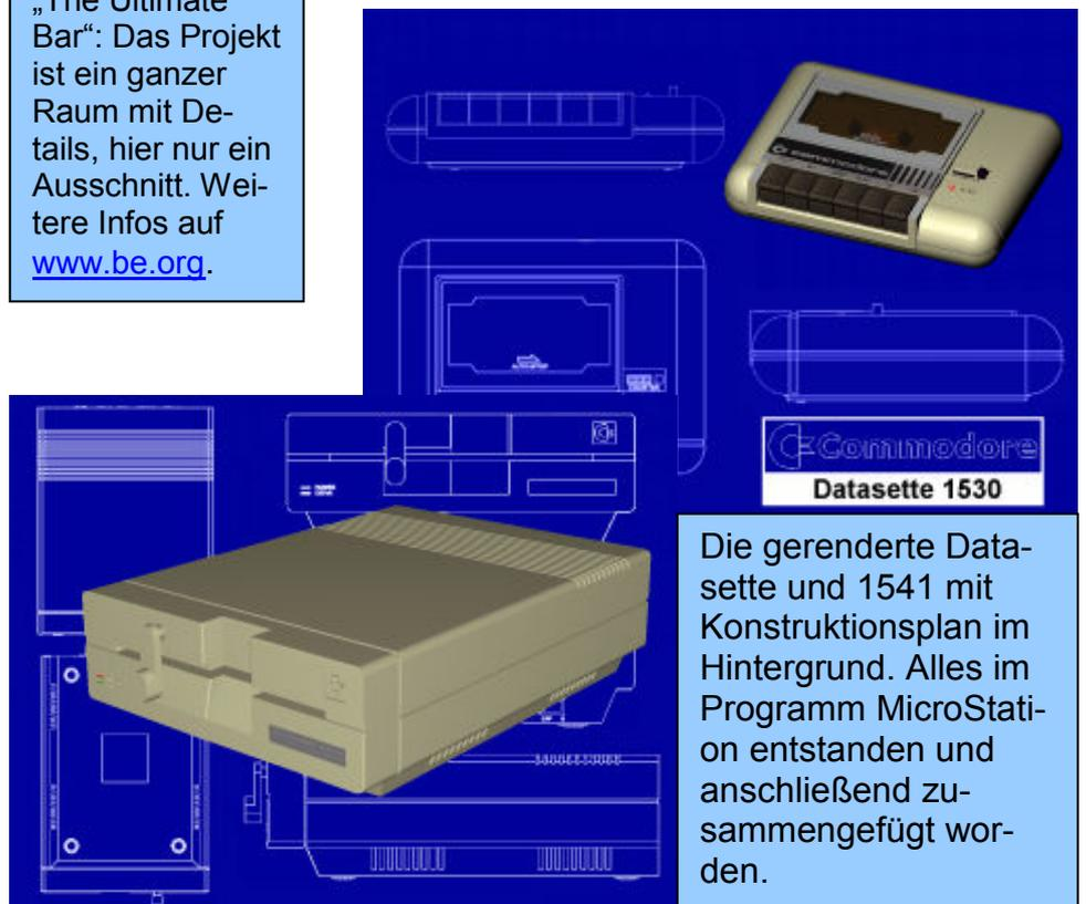
Die gerenderte Datasette und 1541 mit Konstruktionsplan im Hintergrund. Alles im Programm MicroStation entstanden und anschließend zusammengesetzt worden.
