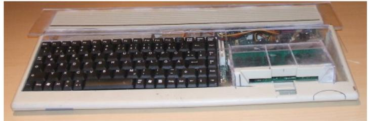
Laufwerk gedacht gewesen, aber leider ging das nicht anders. Das CD-Laufwerk wird jetzt an der Seite herausgeführt. Als CD-Laufwerk ist ein Slimline. Das Laufwerk ist mittels Adapter (mini IDE auf IDE) angeschlossen.
