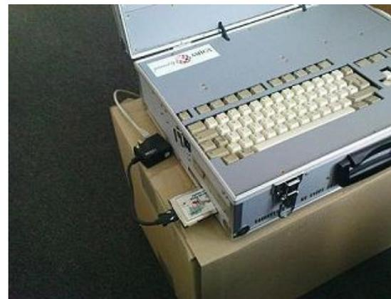
Die andere Seite mit dem PCMCIA - Kartenslot und dem DD - Diskettenlaufwerk. Im PCMCIA - Slot zu sehen: eine CNet Netzwerkkarte.
