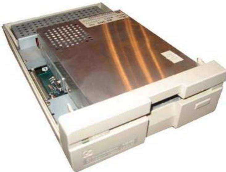
Hat man das Gehäuse offen, ist das Laufwerk darunter auf einem Metallrahmen befestigt. Hinten zwei Anschlüsse, die man leicht abziehen kann.
