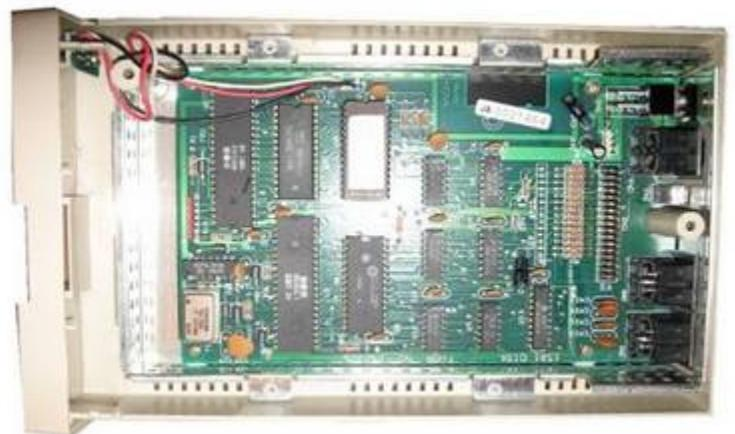
Nach dem Abmontieren des Metallrahmens sieht man die sehr kleine und hoch integrierte Platine des 1581 Laufwerks.
