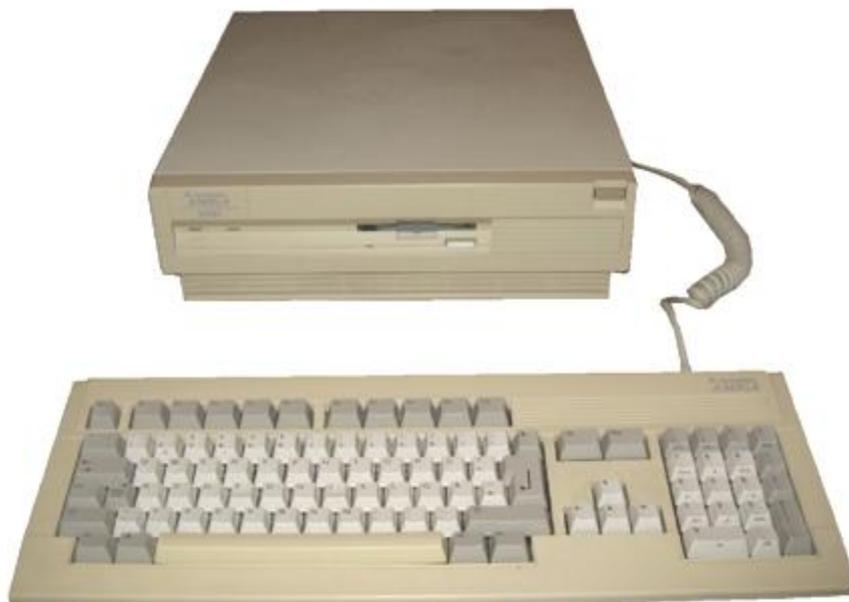
Hier der Amiga 3000 ohne Tastatur in seinem Auslieferungszustand mit einem Laufwerk. Ein weiteres Diskettenlaufwerk kann intern montiert werden. Leider gibt es keinen 5,25" Einschub für CD-Rom-Laufwerke. Vorne zwei LEDs für POWER und HARD DISK.
