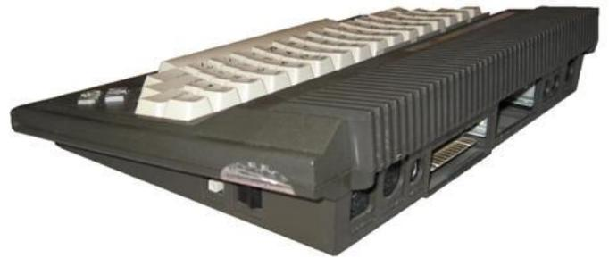
Durch die kompakte Bauform haben nicht alle Anschlüsse hinten Platz. An der linken Seite findet sich daher der RF-Modulator.
