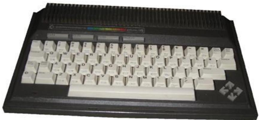
Im Gegensatz zum C16 ist hier die Tastaturbelegung und -beschriftung logischer. Auch die Pfeiltasten sind einzelne, besser angeordnete Tasten vorgesehen. Zudem ist die Tastatur sehr flach und angenehm. Wie beim C16 gibt es statt F8 eine HELP-Taste, die dazu dient, Fehler in BASIC-Programmen zu finden.
