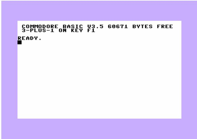
Der Plus4 hat 64 KB Speicher von denen ca. 60 für BASIC Programme zu Verfügung stehen. Zusätzlich hat er die eingebaute "3 plus 1" Software, die mit F1 oder dem Befehl "SYS 1525" gestartet werden kann. Das BASIC ist Version 3.5 und stark erweitert gegen ältere Versionen. So gibt es nun z.B. Befehle für Grafik und Sound. Wie beim C16 hat der Start-Bildschirm die Farben weiß mit violett. Die Schrift ist schwarz und daher gut lesbar.
