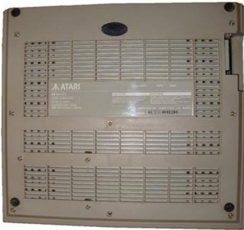
An der Unterseite das sehr große Typenschild. Fast die ganze Unterseite besteht aus Lüftungsschlitzen. Oben mittig das Garantiesiegel.
