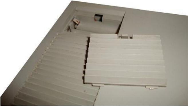
Links hinten sehr gut versteckt und kaum sichtbar: Das Batteriefach. Hier kann man zwei Batterien des Typs AA einsetzen, um die Echtzeituhr auch im ausgeschalteten Zustand mit Strom zu versorgen. Im Vordergrund liegt die Abdeckung.
