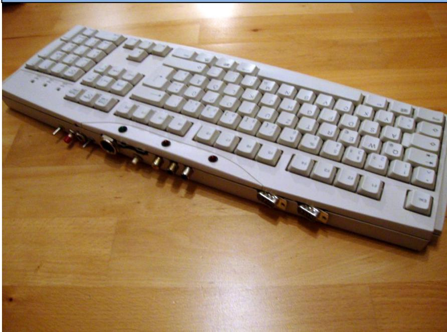
Anschlüsse auf der Rückseite. Rechts neben dem großen Serial Port sieht man den SD-Slot. Die Joystickbuchsen wurden vorerst schräg eingebaut, um eine sichere Position ohne fixe Befestigung zu gewährleisten.
