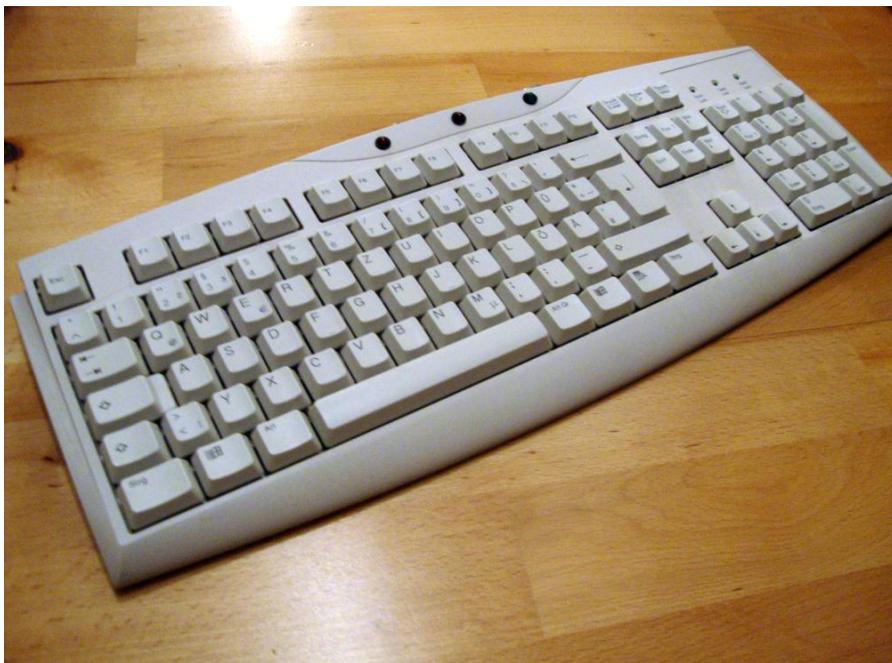
Der C64 DTV Umbau hat oben drei LEDs für Power (rot), SD2IEC Power (rot) und Drive LED (grün). Die Tastatur-LEDs rechts oben sollen mit einem Commodore-Logo verdeckt werden. C64 Tastaturaufkleber sollen später noch mehr C64-Bezug herstellen.
