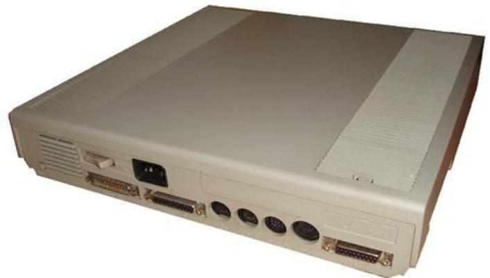
Ganz links der Reset-Schalter. Daneben der Lüfter. Oben der Ein-/Ausschalter, Stromanschluss, Erweiterungs SLOT mit Abdeckung sowie ein eingepprägtes Atari Logo. Unten die Anschlüsse von rechts nach links: Harddisk, Floppy, spezieller Monitoranschluss, zwei MIDI-Ports, Parallel und Modem. sowie Festplatte, Modem und Drucker.
