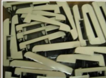
Neue C64x Gehäuse aus der Produktion.
