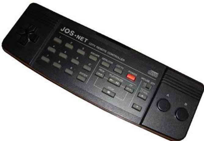
Der CDTV-Controller wurde auch von der Firma JOS NET vermarktet. Der JOS-NET Controller unterscheidet sich technisch nicht vom Original. Nur der Aufdruck vorne sowie japanische Zeichen an der Rückseite sind unterschiedlich zum Commodore-Controller. Er funktioniert an allen CDTV.
