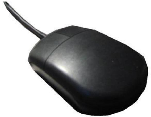
Hier die CDTV-Kabelmaus CD1253. Sie entspricht den modernen, runden Amiga Mäuse, hat jedoch einen anderen Anschluss (ähnlich dem eines PS/2 Anschlusses am PC). Es gab auch eine kabellose Maus, die komplett anders aussah und mit Infrarot arbeitete.
