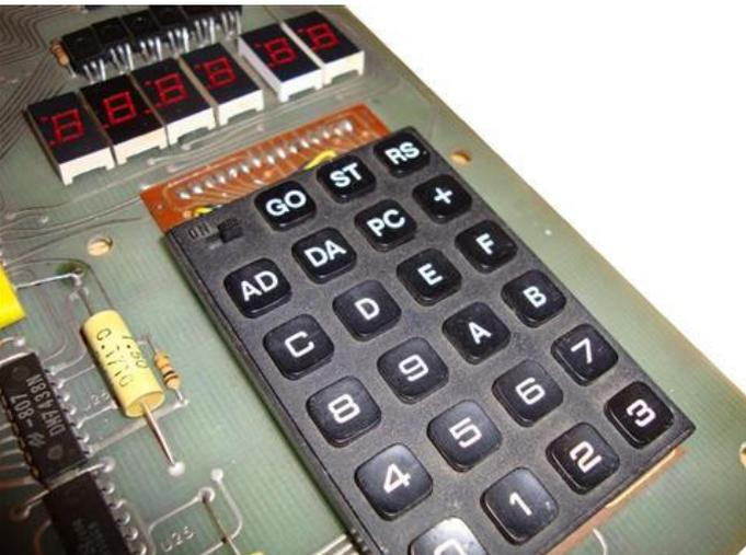
Die kleine Tastatur mit 23 Tasten dient der Eingabe von HEX-Codes. Links oben befindet sich der ON/OFF Schalter. Darüber ist die LED-Segmentanzeige - ähnlich wie bei Taschenrechnern - zu sehen. In der ersten MOS Version mit REV A wurde ein etwas anderes Display und eine leicht geänderte Tastatur verbaut (vergleiche Rev A: [externer Link](#).)
