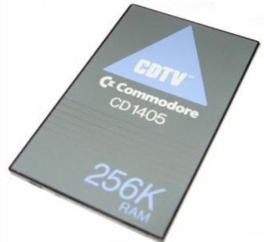
Hier die eine der sehr seltenen 256 KB RAM Karten für das CDTV. Eine kleine 3V Knopfzellen-Batterie hält die RAM-Chips unter Strom, damit die Daten bei ausgeschaltetem Gerät oder beim Transport nicht verloren gehen. Diese 256 KB RAM Karte kostete damals halb so viel wie ein CDTV und ist daher selten.
