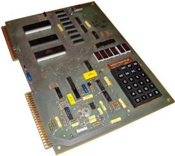
Auslieferungszustand des KIM-1: eine fertige Platine mit allen Bauteilen, kleiner Tastatur und LED-Anzeige. Links oben der größere Chip ist der MOS 6502 Prozessor, darunter sind die beiden 6530 Multifunktions-Bausteine. Es gibt die unterschiedlichsten Farben der Platine.
